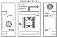
※吸気口あるいは排気口がフィルタつきの場合、目詰まりによる効率低下を防ぐ ために定期的な清掃を行ってください。
