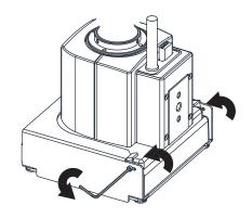
②FZ-SLC15から拡散板をはずします。 拡散板にキズをつけないために、乳白色の板部分が FZ-SLC15と接触しないよう、注意してください。
