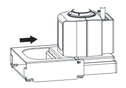
③拡散板の止め具を回し、FZ-SLC15の照明を押さえます。 その後,付属の六角レンチでネジをしっかりと締めてください。 (推奨トルク値: 0.25Nm)
